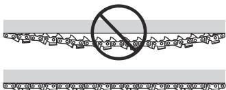
износване на направляващата шина, веригата за моторния трион и задвижващия венец на веригата се увеличава.
