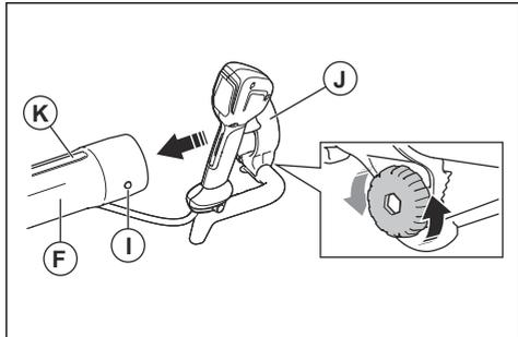
7. Collegare l'impugnatura (J) al binario di guida (K) dello snodo girevole (F). Accertarsi che la vite sull'impugnatura si trovi sul lato inferiore del tubo di manovra.
