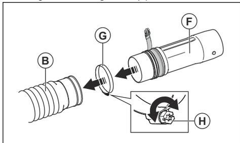
5. Inserire la vite (H) sul morsetto sotto il tubo e serrare la vite.
