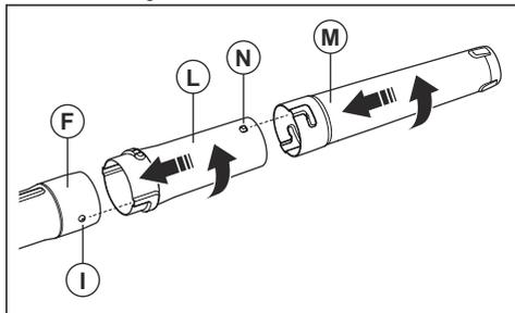
10. Ruotare completamente il tubo intermedio (L) per bloccare lo snodo girevole (F) e il tubo intermedio.
