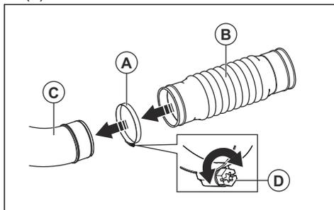
2. Inserire la vite (D) sul morsetto sotto il tubo e serrare la vite.
