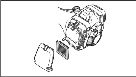
4. Controllare e pulire l'alloggiamento del filtro dell'aria con una spazzola.
