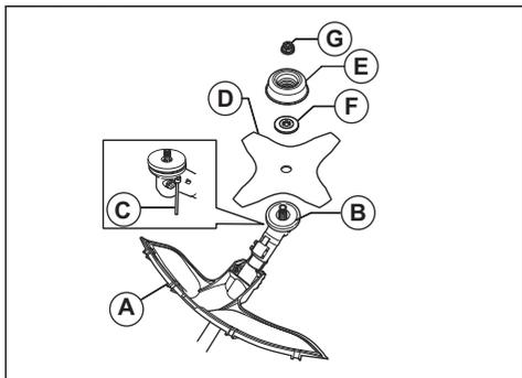
6. Assicurarsi che il menabrida e la flangia di sostegno si inseriscano correttamente nel foro centrale della lama tagliaerba.
