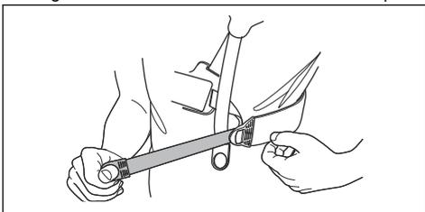
5. Regolare la cinghia a bandoliera fino a ripartire il peso in modo uniforme sulle 2 spalle.
