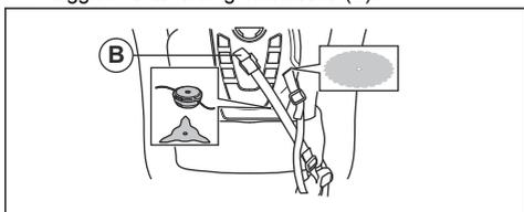
10. Regolare le cinghie delle spalle per bilanciare la distribuzione del peso sulle spalle.
