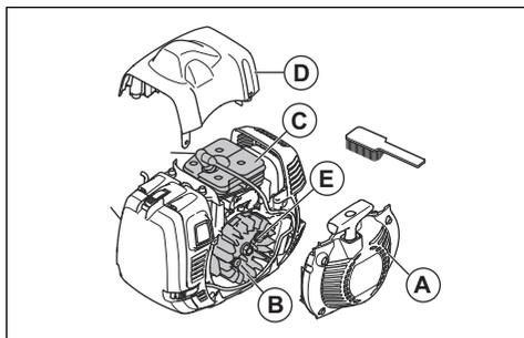
Pulire il sistema di raffreddamento una volta alla settimana o più spesso, se necessario.
