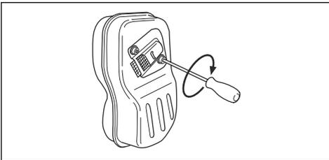
4. Wenn der Schalldämpfer an Ihrem Produkt einen Funkenschutz hat, führen Sie eine Sichtkontrolle durch.
