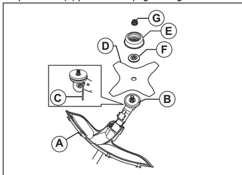
6. Poskrbite, da se pogonski disk in oporna prirobnica pravilno zaskočita v središčno odprtino noža za travo.
