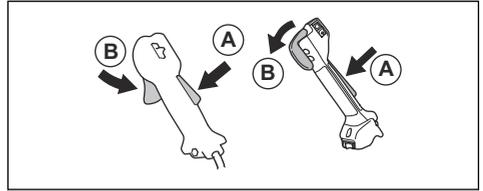
3. Lassen Sie den Hebel los, und stellen Sie sicher, dass die Gashebelsperre (A) und der Gashebel (B) wieder in ihre Ausgangsstellung gehen.
