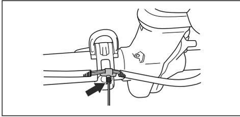
5. Überprüfen Sie die Gummibälge auf dem Draht, um sicherzustellen, dass diese sich nicht ausdehnen.
