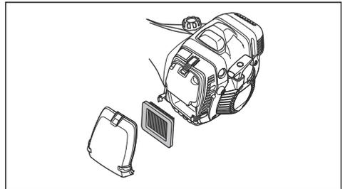
4. Preglejte ohišje zračnega filtra in ga očistite s krtačo.
