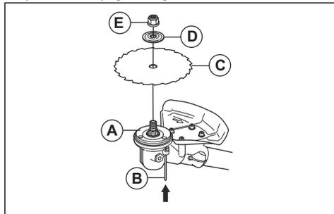
5. Poskrbite, da se pogonski disk in oporna prirobnica pravilno zaskočita v središčno odprtino noža za travo.
