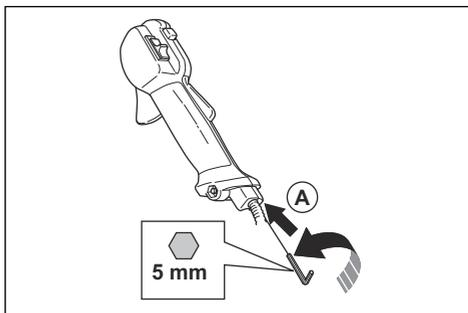
4. Če je hitrost plina pri zagonu višja od 6500 vrt/min, obrnite nastavitveni vijak (A) v nasprotni smeri urinega kazalca. Ko se začne rezalni priključek vrteti, obrnite nastavitveni vijak (A) za pol obrata.
