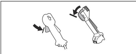
2. Drücken Sie die Gashebelsperre (A). Stellen Sie sicher, dass der Gashebel (B) freigegeben ist.
