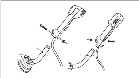
3. Das Loch im Handgriff für die Befestigungsschraube über das Loch im Lenker schieben.
