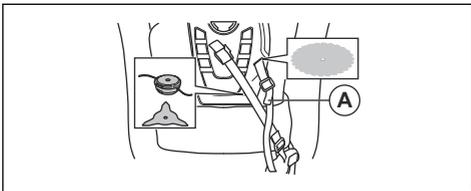
5. Ziehen Sie den Hüftgurt fest an. Stellen Sie sicher, dass der Hüftgurt auf einer Höhe mit der Hüfte liegt.
