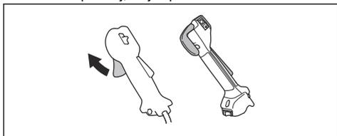
6. Zaženite motor in pritisnite polni plin.
