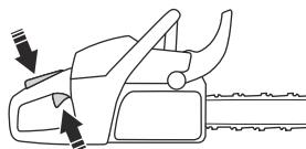
8. 将前护手向后移动可分离链制动机。
