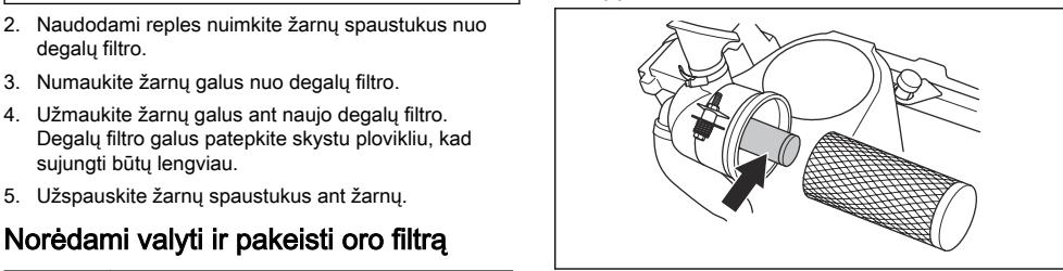
7. Trinteklėkite vidinį oro filtrą į kietą paviršiu, kad jį išvalytumėte. Pakeiskite oro filtrą, jei jis nepasidaro švarus arba yra pažeistas.
