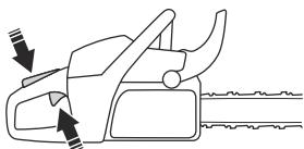
8. Pociągnąć dźwignię hamulca do tyłu, aby zwolnić hamulec piły łańcuchowej.
