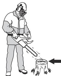
3. Testere zinciri yağlama sistemi doğru çalışmayıorsa kılavuzu kontrol edin. Talimatlar için bkz. *Kılavuzu kontrol etme sayfası: 416. Bakım adımları yardımcı olmazsa servis bayinizi iletişime geçin.*
