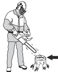
3. Ako podmazivanje lanca motorne pile ne funkcioniše ispravno, provjerite vodilicu. Za upute pročitajte *Provjera vodilice na stranici 150*. Ako mjere održavanja ne pomognu, razgovarajte sa svojim servisnim zastupnikom.
