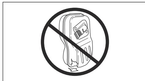
**Poví慎něte si:** Vnitřní povrchy tlumiče výfuku obsahují chemikálie, které způsobují rakovinu. Nedotýkejte se těchto prvků, pokud je tlumič poškozený.
