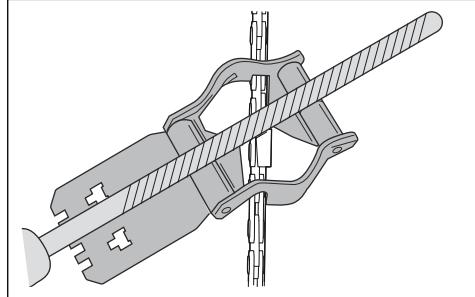
4. Uklonite materijal s jedne strane svih reznih zubaca.
