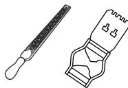
1. Plosnatom turpjom i alatom mjerača dubine podesite postavku mjerača dubine. Upotrebljavajte samo alat mjerača dubine proizvođača Husqvarna da biste dobili ispravnu postavku mjerača dubine i kut mjerača dubine.
