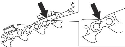
2. Pobrinite se da se lanac motorne pile može lako savijati. Zamjenite lanac motorne pile ako je krut.
