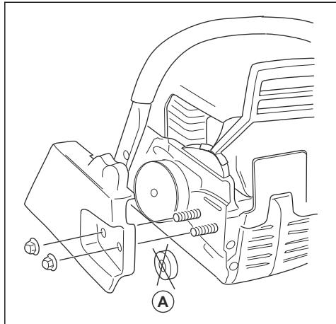
**Napomena:** Ako se poklopac spojke ne može lako skinuti, pritegnite maticu vodilice, povucite pa otpustite kočnicu lanca. Ako je ispravno otpustite, začut će te škjlocaj.
