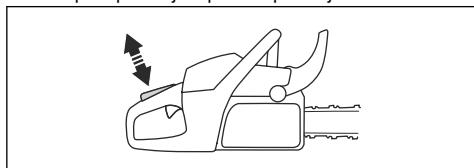
3. Provjerite je li regulator gase blokirana u praznom hodu pri otpuštanju blokade regulatora gase.
