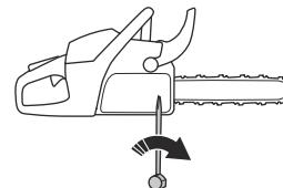
5. Pritežite matice vodilice ključem i istovremeno podižite prednji dio vodilice.
