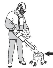
3. Ako podmazivanje lanca motorne pile ne funkcionira ispravno, provjerite vodilicu. Za upute pročitajte *Provjera vodilice na stranici 30.* Ako mjere održavanja ne pomognu, razgovarajte sa svojim servisnim zastupnikom.
