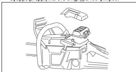
**Περιεχόμενα** Το προϊόν μπορεί να χρησιμοποιηθεί με διάφορους τύπους φίλτρου αέρα ανάλογα με τις διάφορες συνθήκες εργασίας, τις καιρικές συνθήκες και
