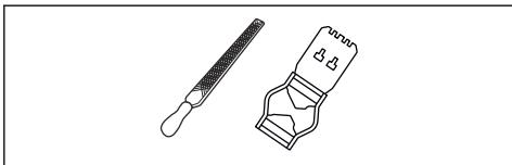
1. Χρησιμοποιήστε μια επιπέδη λίμα και ένα όργανο μέτρησης βάθους για να προσαρμόσετε τη ρύθμιση του μετρητή βάθους. Χρησιμοποιήστε μόνο το όργανο μέτρησης βάθους της Husqvarna για να επιτύχετε τη σωστή ρύθμιση του μετρητή βάθους και τη σωστή γωνία για το μετρητή βάθους.
