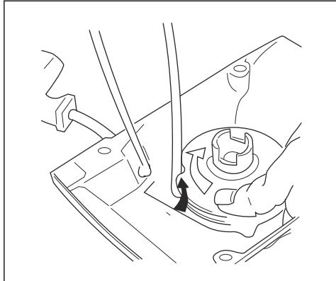
5. 卸下中心螺钉，拆下皮带轮。
