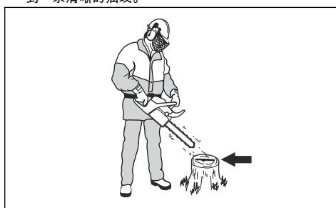
3. 如果锯链润滑工作不正确，则检查导板。有关说明，请参阅 **检查导板 第 27 页**。如果维护步骤无所帮助，请联系保养代理商。
