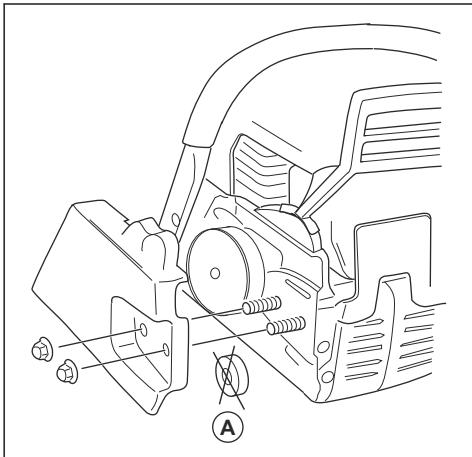
**注释:** 如果离合器罩难以拆下，则拧紧导板螺母，接合链制动器，然后松开。如果正确松开，会听到一声咔哒声。
