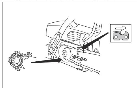
6. 将导板中的孔与链条张紧螺钉对齐，然后安装离合器罩。
