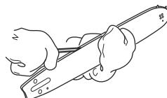
4. 检查导板槽是否磨损。必要时请更换导板。
