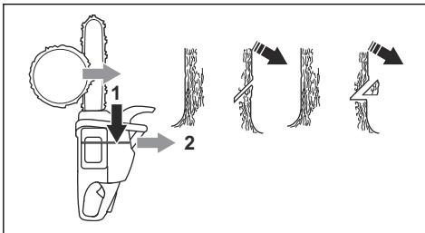
2. 确保底部方向切口水平，并与倒落方向成 90° 角。
