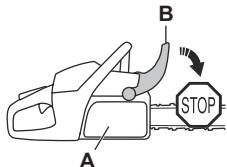
将前护手向后拉动可分离链制动器。
