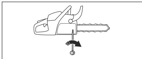
5. 用扳手拧紧导板螺母，同时提起导板前部。
