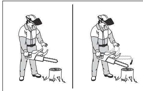
5. 当导板端头碰到树桩时，确保链制动机启动。
