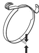
2. 检查制动带。制动带最薄点的厚度必须至少为 0.6 毫米/0.024 英寸。
