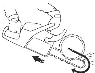
**警告:** 如果锯链卡在树干中，产品可能会被推向你所在的方向。牢牢握住产品，确保导板反弹区不会接触树木和导致反弹。
