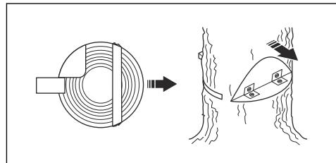
4. 切断安全角，使树木倒落。
