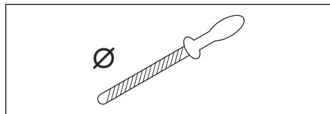
如果不使用适合的设备，则很难正确磨利锯链。使用 Husqvarna 锉规。这将有助于保持最大锯切性能并将反冲危险降至最低。
