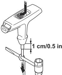
**Περιεχόμενα** Εάν κοπεί το σχοινί εκκίνησης στη λαβή, πιέστε προς τα κάτω το κάλυμμα της λαβής του συστήματος εκκίνησης. Χρησιμοποιήστε το γερμανοπολύγυρο κλειδί για να αφαιρέστε το κάλυμμα της λαβής του συστήματος εκκίνησης.
