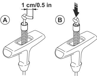
15. Τραβήξτε το σχοινί εκκίνησης μέχρι να φανεί 1 cm από τον οδηγό του ελατηρίου. Ταυτόχρονα, συναρμολογήστε το κάλυμμα της λαβής του συστήματος εκκίνησης.
