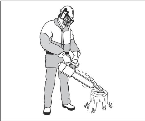
4. Wenn die Sägekettenschmierung nicht ordnungsgemäß funktioniert, führen Sie eine Prüfung der Führungsschiene durch. Eine Anleitung finden Sie in *So prüfen Sie die Führungsschiene auf Seite 27*. Wenden Sie sich an den Kundendienst, wenn Sie mit den Wartungsschritten das Problem nicht beheben können.
