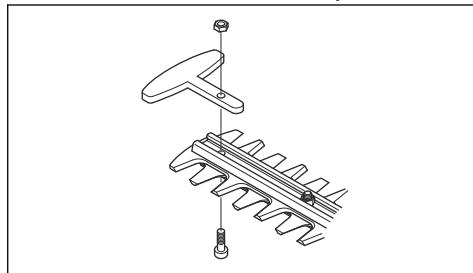
2. Ugradite vijak i maticu na reznu jedinicu i zategnite na 8 Nm.
