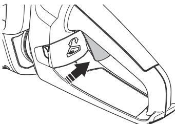
4. Otpustite okidač paljenja i provjerite ispravnost povratne opruge. Nož se mora zaustaviti za manje od jedne sekunde.
