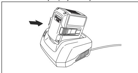
3. Provjerite uključuje li se zeleni indikator punjenja na punjaču baterije. On označava ispravnu povezanost baterije s punjačem baterije.
