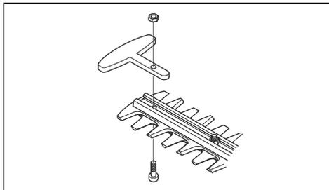
2. Coloque o parafuso e a porca na unidade de corte e aperte a 8 Nm.
