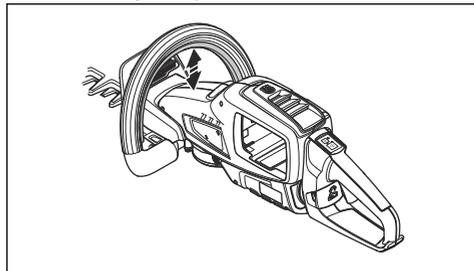
3. Para aplicar uma rotação máxima, prima totalmente o interruptor de alimentação.
