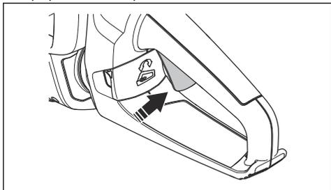
4. Suelte el gatillo de alimentación y asegúrese de que el muelle de retorno funciona correctamente. La cuchilla debe detenerse en menos de 1 segundo.
