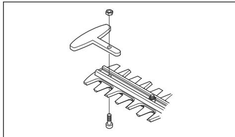
2. Monte el tornillo y la tuerca en la unidad de corte y apriete a 8 Nm.
