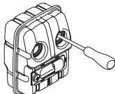
Pokud je tlumič výfuku na stroji vybaven lapačem jisker, musí se sítko lapače pravidelně čistit. Ucpané sítko lapače způsobuje přehřátí motoru a může vést k vážnému poškození stroje.
