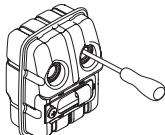
Jeśli tłumik w Twojej maszynie jest wyposażony w siatkę przeciwiskrową, należy ją regularnie czyścić.
