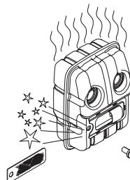
U tlumiče zvuku bez katalyzátoru je zapotřebí sítko čistit a eventuálně vyměnit jednou týdně. U tlumiče zvuku s katalyzátorem je zapotřebí sítko kontrolovat a eventuálně čistit jednou měsíčně. **Poškozenou sítku je nutno vyměnit.** Často znečištěná sítna indikuje sníženou funkčnost katalyzátoru. Požádejte vašeho prodejce o provedení kontroly funkce katalyzátoru. Znečištěná sítna způsobuje přehřívání motoru a tím poškození válce a pístu.
