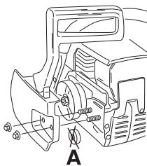
Установите пильное полотно на специально предназначенные болты. Установите полотно в самое заднее положение. Оденьте цепь на ведущую звездочку и вставьте ее хвостовики в паз пильного полотна. Начинайте с верхней стороны пильного полотна. Убедитесь, что кромки режущих эвеньев направлены вперед на верхней стороне пильного полотна.
