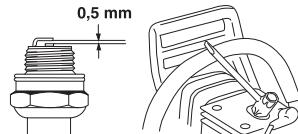
Обратите внимание! Всегда используйте только указанный тип свечи! Применение несоответствующей модели может привести к серьезным повреждениям поршня/цилиндра. Следите за тем, чтобы свеча была оснащена т.н. изоляцией радиопомех.
