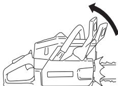
Desatarraxe inteiramente as porcas e remova a cobertura de acoplamento (travão de corrente). Retire o protector para transporte (A).
