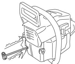
A corrente está correctamente esticada quando não mais estiver frouxa na parte inferior da lâmina e ainda possa ser girada facilmente com a mão. Aperte bem as porcas da lâmina com a chave universal ao mesmo tempo que segura a extremidade da lâmina.
