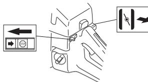
Se a máquina estiver equipada com uma válvula descompressora (A): Comprima a válvula para diminuir a pressão no cilindro, o que facilita o arranque da máquina. A válvula descompressora deve usar-se sempre no arranque. Quando a máquina arranca, a válvula retorna automaticamente à posição original.
