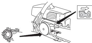
Monte a cobertura do acoplamento e localize o pino do esticador da corrente no encaixe da lâmina. Verifique se os elos de condução da corrente passam pelo pinhão da corrente e se a corrente está em posição correcta na
