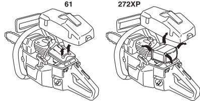
Uma limpeza mais completa obtém-se ao lavar o filtro com água e sabão.
