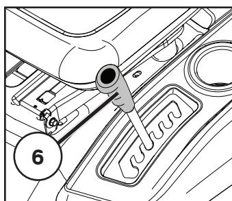
**(RU) 6. Быстрый подъем/опускание режущего блока**
