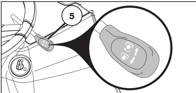
**(RU) 5. Подключение/отключение режущего блока.**
