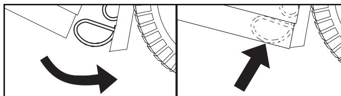
**NOTĂ:** Dacă se regleză înălțimea ansamblului sacului, poate fi necesar să se regleze înălțimea arcului sacului, pentru a menține ansamblul sacului bine închis. Pentru a o regla, slăbiți piulița (4) suficient încât să permiteți închizătorii cu arc a sacului să se deplaseze. Faceți să alunece închizătoarea cu arc pentru sac în sus sau în jos, după necesități, având grija ca ansamblul sacului să fie închis foarte bine. Strâneță din nou piulița foarte bine.
