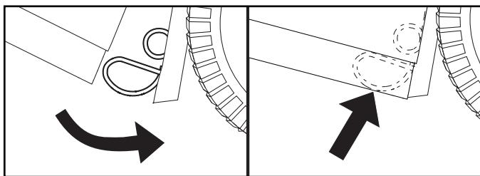
**ПРИМЕЧАНИЕ:** если выполнена регулировка высоты узла сборника, может потребоваться отрегулировать высоту пружины сборника, чтобы обеспечить его надежное закрытие. Для осуществления регулировки ослабьте гайку (4) настолько, чтобы пружинная защелка сборника смогла перемещаться. Переместите пружинную защелку сборника вверх или вниз по мере необходимости, убедившись в том, что узел сборника будет надежно закрыт. Снова прочно затяните гайку.
