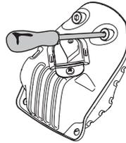
一些消音器配有专门的火花挡网。如果您的机器安装的是此类消音器，则至少要一周清洁一次挡网。最好用钢丝刷进行清洁。挡网堵塞会导致引擎过热，造成严重损坏。
