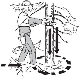
移除树根处的任何下层灌木丛，检查区域内有无障碍物（石块、树枝、洞口等），以便树木开始倒落时让您拥有畅通无阻的退路。您的退路应距离预计倒向大约 135 度。
