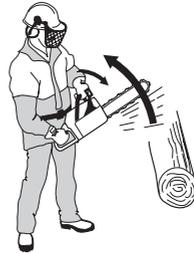
如果反冲不甚剧烈，或者导板反冲区域距离您较近，则链制动器将由您通过移动左手手动启用。
