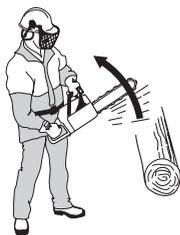
只有当导板的反冲区接触物体时才会出现反冲现象。
