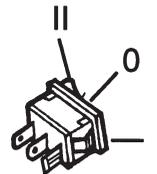
Положення "0" - перемикач вимкнено, положення "I" - струм подається на підігрів тримача, положення "II" - струм подається на карбюратор.
