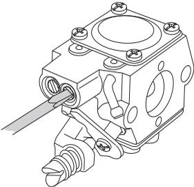
Коли ланцюгова пилка обладнана карбюратором, який має обмежувачі руху, карбюратор повинен бути відрегульований згідно з інструкціями, наведеними під заголовком 'Карбюратор з обмежувачами руху'.
