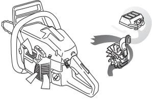
**ВАЖЛИВО!** Для підтримки роботи системи відцентрового очищення її треба регулярно доглядати. Прочистіть забирач повітря на стартері, ребра на маховику, простір біля маховику, впускну трубу та відсік карбюратора.
