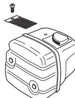
Глушник призначений для зменшення рівня шуму та відведення вихлопних газів подалі від користувача. Вихлопні гази мають високу температуру і містять іскри, які, потрапивши на
