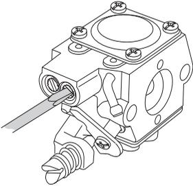
Карбюратор може мати різні конфігурації, залежно від діючого законодавства щодо захисту середовища та викиду газів. Деякі ланцюгові пилки обладнані обмежувачами руху на затяжних гвинтах карбюратора. Вони обмежують діапазон регулювання щонайбільше до 1/2 оберту.
