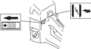
Якщо інструмент обладнаний клапаном зниження тиску (A): Натисніть на клапан, щоб зменшити тиск у циліндрі та полегшити запуск. Завжди використовуйте клапан зниження тиску при запуску інструмента. Після того як
