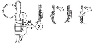
Направляючі вирізи повинні бути зроблені на глибину 1/4 діаметра стовбура та кут між нижнім та верхнім розрізами має бути 45°.
