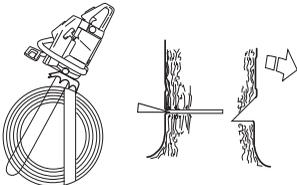
Закінчіть робити виріз зрізування паралельно лінії напрямку розрізу, щоб відстань між ними була не менш 1/10 діаметра стовбура. Нерозрізана частина стовбура називається розріз падіння.
