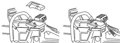
Фільтр може бути очищений ще краще промиванням його у воді з миючим засобом.
