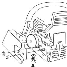
Закріпіть направляючу шину гвинтами. Установіть направляючу шину. Одягніть ланцюг на барабан приводу на канавці направляючої шини. Почніть із верхньої крайки направляючої шини.
