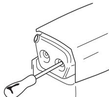
Деякі глушники обладнано іскропоглинаючими сітками. Якщо інструмент обладнано глушником такого типу, сітку слід чистити принаймні раз на тиждень. Найкраще робити це дротяною щіткою. Забруднена сітка призведе до перегрівання двигуна, що може спричинити серйозне його пошкодження.
