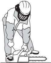
Zatlačte ovládanie sýtiča hneď, ako motor odpáli a opakujte, pokiaľ motor nenaštrtuje. Keď motor naštartuje, rýchlo pridajte na plný plyn a štartovací plyn sa automaticky uvoľní.
