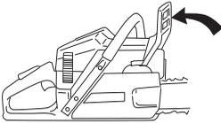
Odkręć nakrętki znajdujące się na prowadnicy i odłącz osłonę sprzęgła (hamulec łańcucha). Zdejmij zabezpieczenie transportowe (A).
