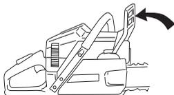
Odšroubujte matice lišty a sejměte kryt spojky (brzdu řetězu). Vyjměte přepravní ochranný kroužek (A).
