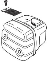
Tłumik przeznaczony jest do tłumienia hałasu i odrzucania gazów spalinowych poza strefę pracy operatora. Gazy spalinowe mają wysoką temperaturę, a znajdujące się w nich iskry mogą spowodować pożar, jeżeli skierowane zostaną w stronę materiałów suchych i łatwopalnych.
