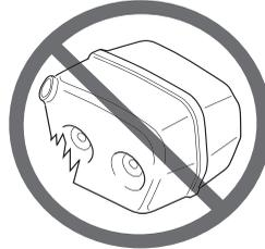
Pravidelne kontrolujte, či je tlmič výfuku pevne pripravený k motoru.
