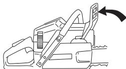
Odstráňte matice z krytu vodiacej lišty a zložte kryt spojky (brzda reťaze). Dajte dolu prepravný krúžok (A).
