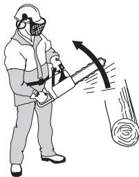
Odbicie powstaje wyłącznie w momencie zetknięcia się strefy odbicia prowadnicy z twardym przedmiotem.
