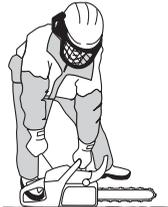
Natychmiast po zaskoczeniu silnika wciśnij dźwignię ssania. Powtarzaj operację uruchamiania aż do uruchomienia silnika. Po uruchomieniu silnika, bezzwłocznie dociśnij dźwignię gazu do oporu, przez co zostaną automatycznie wyłączone obroty rozruchowe.
