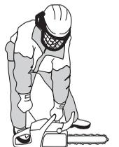
Jakmile motor naskočí, zasuňte páčku sytiče a tahejte, dokud motor nenastartuje. Po nastartování motoru rychle přidejte plyn až do plných otáček; pojistka páčky plynu se automaticky vypne.
