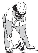
Čim motor počne da pali pritisni regulator sauga i ponavljaj pokušaje paljenja. Kad se motor upali brzo daj pun gas. Onda će se kočnica gasa otpustiti.
