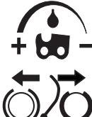
Travão da corrente, activado (direita) Travão da corrente, não activado (esquerda)
