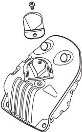
Глушитель служит для снижения уровня шума и отвода раскисленных выхлопных газов от рабочего. Выхлопные газы очень горячие и
