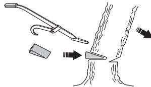
Мы рекомендуем пользоваться шиной пилы, длина которой бы превышала диаметр ствола, чтобы валяющий и направляющий срезы могли выполняться т.н. "одинарным срезом". См. указания в разделе Технические данные,
