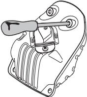
В некоторых глушителях предусмотрен специальный искрогаситель. Если ваша машина оборудована таким глушителем, сетку фильтра следует чистить раз в неделю. Наилучшие пользователи стальной щеткой. Забитая решетка приводит к работе с горячим двигателем, что дает серьезные повреждения двигателя.
