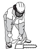
Нажмите красный регулятор управления воздушной заслонкой, как только заработает двигатель (это можно определить по характерному звуку). С силой вытягивайте шнур, пока не запустится двигатель.
