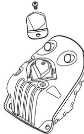
**ВНИМАНИЕ!** Глушитель при пользовании и сразу после остановки двигателя очень горячий. Это справедливо также при работе на холостых оборотах. Помните о риске пожара, в особенности при работе рядом с легко воспламеняемыми веществами и/или газами.
