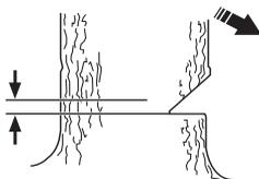
Вставьте зубчатый упор (если установлен) сзади надреза. Работайте на полном газу и вводите пильное полотно в ствол дерева постепенно, плавным движением. Следите за
