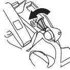
Afferrare saldamente l'impugnatura anteriore con la sinistra. Porre il piede destro sulla parte inferiore della maniglia posteriore e premere la motosega contro il terreno. Tirare lentamente la cordicella con la destra, fino a quando fa resistenza (entra in presa il dispositivo di avviamento) e tirare quindi con strappi decisi e veloci. **Non avvolgere mai la cordicella di avviamento intorno alla mano.**
