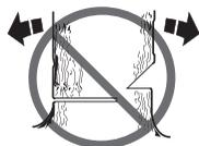
Per l'abbattimento di un albero raccomandiamo di usare una lama più lunga del diametro del tronco, in modo da poter eseguire i tagli di direzione e di abbattimento con un taglio semplice. Vedi capitolo Caratteristiche tecniche per la lunghezza della lama consigliata per il vostro modello di motosega.
