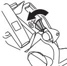
Κρατήστε την μπροστινή λαβή με το αριστερό σας χέρι. Κρατήστε το αλυσοπρίσιο στο έδαφος τοποθετώντας το δεξί σας πόδι μέσα στην πίσω λαβή. Τραβήξτε τη λαβή εκκίνησης με το δεξί σας χέρι και τραβήξτε αργά το καλώδιο εκκίνησης λειτουργίας μέχρι να αισθανθείτε κάποια αντίσταση (καθώς τα καστάνια του καλωδίου εκκίνησης λειτουργίας σφίγγουν) και, στη συνέχεια, τραβήξτε το σταθερά και γρήγορα. Ποτέ μην τυλίγετε το κορδόνι εκκίνησης στο χέρι.
