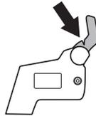
フロントハンドガードを前後に動かしてみて、スムーズに動くか、クラッチカバーで確実に止まるかなどを点検します。
