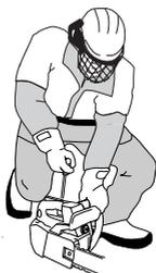
ブツと吹き出るような音と共にエンジンが点火したら、チョークコントロールを押します。エンジンが始動するまでロープを強く引き続けます。エンジンが始動したら、すぐにフルスロットルにします。スロットルスタートロックは自動的に解除されます。
