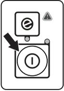
注意！要避免意外启动，机器不使用或无人看管时，务必取出电池。要取出电池，按电池上的电池释放按钮的同时将其从机器中拉出。
