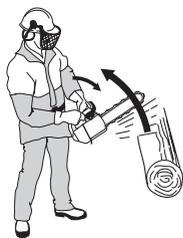
如果反冲不甚剧烈，或者导板反冲区域距离您较近，则链制动器将由您通过左手操作以手动启用。
