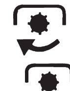
Разъединение механизма отбора мощности
