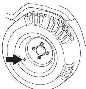
Давление воздуха в поворотном колесе режущего блока должно составлять 1,5 бара/150 кПа/22 psi.
