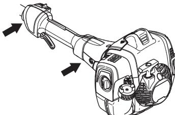
Systém na tlmenie vibrácií znížuje prenos vibrácií medzi motorovou jednotkou/rezným zariadením a rukoväťami stroja.
