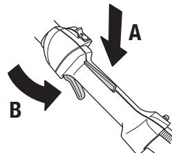
Zkontrolujte, zda při uvolnění pojistky páčky plynu zapadne páčka plynu do polohy, při které je motor ve volnoběžných otáčkách.
