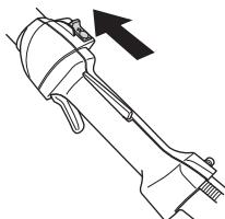
**VAROVÁNÍ!** Vypínač se automaticky vrátí do výchozí polohy. Abyste se při montáži, kontrole a/nebo údržbě vyhnuli nezamýšlenému nastartování je nutno vždy odejmout rozbušku od zapalovací svíčky.
