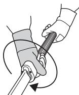
**VAROVÁNÍ!** Po překročení koncové polohy jsou nože zablokované, pokud je sekací jednotka v této poloze, neprovádějte sekání.
