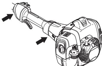
Antivibrační systém stroje snižuje přenos chvění mezi jednotkou motoru/řezným mechanismem a rukojetí stroje.
