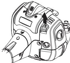
Přitiskněte celý stroj k zemi levou rukou (POZOR! Ne nohou!). Uchopte pravou rukou startovací rukojet' a zvolna vytáhněte startovací lanko až počítíte odpor (v této chvíli došlo k zaskočení západku ve startovacím mechanizmu) a potom rychle a silně za lanko zatahejte. **Nikdy nemotejte startovací lanko kolem ruky.**
