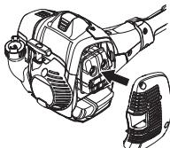
Některé tlumiče výfuku jsou vybaveny speciálním sítkovým lapačem jisker. Pokud vaše zařízení je opatřeno takovým typem tlumiče výfuku, měli byste jeho sítko čistit alespoň jednou za týden. Toto sítko vycistíte nejlépe ocelovým kartáčem.
