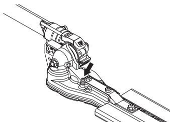
**UPOZORNENIE!** Skriňa prevodovky nesmie byť úplne naplnená mazivom. Pri zahrievaní stroja počas prevádzky sa objem maziva zväčšuje. Ak by bola skriňa prevodovky úplne naplnená mazivom, mohlo by dôjsť k poškodeniu tesnenia a presakovaniu maziva.
