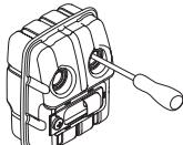
Ha az Ön gépen a kipufogódob szikrafogó hálóval rendelkezik, akkor azt rendszeresen tisztítani kell. Eltömödött háló a motor túlmelegedését okozza, ami a motor komoly károsodásához vezethet.
