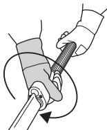
**UPOZORNENIE!** Po dosiahnutí polohy stop sa nože zablokujú, nepokúšajte sa rezať s prístrojom v tejto polohe.
