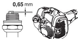
**UWAGA!** Stosuj wyłącznie świece zalecane przez producenta. Niewłaściwa świeca może być przyczyną zatarcia tłoka/cylindra. Dopolnij, aby świeca zapłonowa była wyposażona w tzw. eliminator zakłóceń radiowych.
