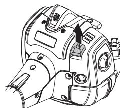
Odmontujte kryt vzduchového filtru a filtr vyjměte. Properte jej v teplé mýdlové vodě. Před jeho zamontováním zpět do stroje je nutno filtr řádně vysušit.
