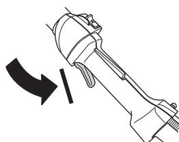
Wcisnij blokadę dźwigni gazu i sprawdź, czy po zwolnieniu nacisku powraca ona do położenia wyjściowego.
