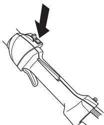
Włącz silnik i sprawdź, czy po przesunięciu wyłącznika w położenie stop silnik zatrzyma się.
