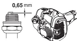
**VAROVÁNÍ!** Vždy používejte doporučený typ zapalovacích svíček! Použití jiného typu zapalovacích svíček by mohlo poškodit píst či válec. Dbejte na to, aby svíčka měla tzv. radiové odrušení.
