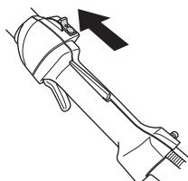
**UWAGA!** Wyłącznik powraca samoczynnie w położenie "start". Dlatego przed przystąpieniem do montażu, kontroli oraz/lub konserwacji należy zawsze zdejmować nasadkę ze świecy zapłonowej w celu zapobieżenia niezamierzonymu uruchomieniu silnika.
