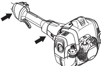
A gép rezgéscsillapító rendszere csökkenti a motorblokk/vágószerszemet rezgéseinek a gép fogantyúja felé történő terjedését.
