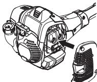
Niekteré tlmiče výfuku sú vybavené špeciálnou sieťkou na zachytávanie iskier. Ak má vaša pila tento typ tlmiča, malí by ste sieťku čistiť aspoň jedenkrát týždenne. Najlepšie sa sieťka čistiť drôtenou kefou.
