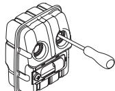
Ak je tlmič výfuku na vašom stroji vybavený zachytávačom iskier, je potrebné ho pravidelne čistiť. Zanesený zachytávač spôsobí prehriatie motora a môže zapríčiniť jeho vážne poškodenie.
