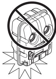
Pravidelne kontrolujte, či je tlmič výfuku pevne pripojený k motoru.
