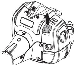
Lavou rukou držte stroj na zemi (**VAROVANIE!** Nepridŕžajte ho nohou!). Uchopte štartovacie držadlo, pravou rukou pomaly potiahnite šnúru, až kým nepocípite istý odpor (západky štartéra sa zachytávajú), a potom šnúru rýchlo a silno potiahnite. **Štartovaciu šnúru si nikdy nemotávajte okolo ruky.**
