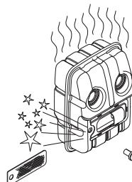
U tlumiče zvuku bez katalyzátoru je zapotřebí sítko čistit a eventuálně vyměnit jednou týdně. U tlumiče zvuku s katalyzátorem je zapotřebí sítko kontrolovat a eventuálně čistit jednou měsíčně. **Poškozenou sítku je nutno vyměnit.** Často znečištěná sítnice indikuje sníženou funkčnost katalyzátoru. Požádejte vašeho prodejce o provedení kontroly funkce katalyzátoru. Znečištěná sítnice způsobuje přehřívání motoru a tím poškození válce a pistu.
