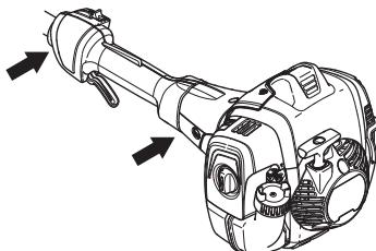
System tłumienia wibracji, w który wyposażona jest maszyna, obniża poziom wibracji przekazywanych na uchwyty z silnika/osprzętu tnącego.
