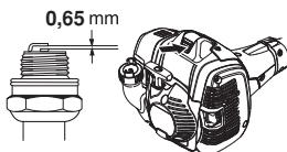
**UPOZORNENIE!** Vždy používajte odporúčaný typ zapaľovacej sviečky! Nesprávna zapaľovacia sviečka môže vážne poškodiť piest/valec. Skontrolujte, či je zapaľovacia sviečka správne nasadená.
