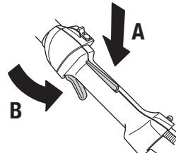
Presvedčte sa, či je ovládanie plynu zablokované pri nastavení na voľnobeh, keď je pojistná páčka plynu uvoľnená.
