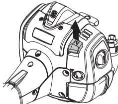
Przyciśnij korpus maszyny do ziemi lewą ręką (UWAGA! Nie stopa!). Ujmij uchwyt rozrusznika prawą ręką i ciągnij powoli, aż poczujesz opór (zazębienie rozrusznika), a następnie szarpnij szybko i energicznie. **Nigdy nie owijaj linki rozrusznika wokół dłoni.**
