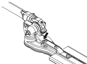
**VAROVÁNÍ!** Převod nelze zcela naplnit mazivem. Mazivo expanduje teplem, které vyuvíjí stroj za chodu. Kdyby byl převod mazivem zcela naplněn, mohlo by dojít ke zničení těsnění a úniku maziva.
