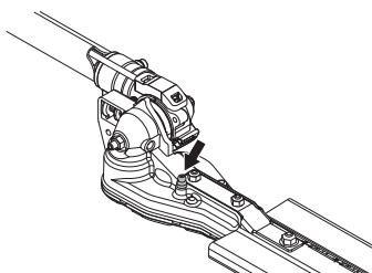
**UWAGA!** Przekładni nie należy napełniać smarem całkowicie. Smar ulega rozszerzalności pod wpływem ciepła powstającego podczas pracy maszyny. W przypadku całkowitego napełnienia przekładni smarem istnieje ryzyko uszkodzenia uszczelki i powstania wycieków smaru.
