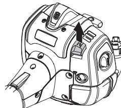
Odstráňte kryt vzduchového filtra a vytiahnite filter. Umyte ho v teplej mydlovej vode. Pred vložením skontrolujte, či je filter suchý.
