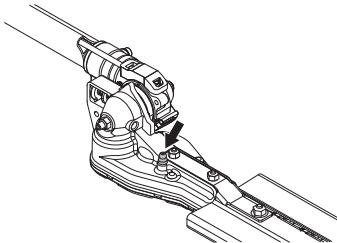
**FIGYELEM!** Az erőátviteli rendszert nem szabad teljesen feltölteni zsírral. A zsír a gép működése közben fejlődő hő hatására kitagul. Ha az erőátviteli rendszert teljesen feltölti zsírral, akkor fennáll a tömítések sérülésének veszélye, amely a zsír szivárgásához vezethet.
