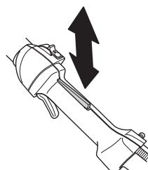
Zkontrolujte, zda se páčka plynu a její pojistka volně pohybují a zda jejich vratné pružiny fungují správně.
