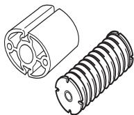
Redovno proveravaj da kod antivibracionih delova nema pukotina ili izobličenja. Prekontrolište da li su elementi za zaštitu od vibracija celi i dobro učvršćeni.
