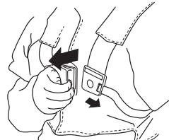
Удостоверьтесь, что привязные ремни оснастки были правильно расположены. Когда машина будет отрегулирована, проверьте работу системы быстрого отстегивания оснастки.
