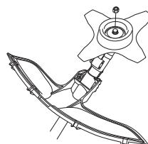
При сборке надо затягивать гайку против направления вращения режущего оборудования. При разборке надо отвинчивать гайку в направлении вращения режущего оборудования. (ЗАМЕЧАНИЕ! Гайка имеет левостороннюю резьбу.) Затяните гайку торцевым гаечным ключом.
