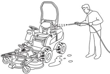
Масляные загрязнения могут быть сняты холодным обезжиривателем. Распылите тонкий слой.
