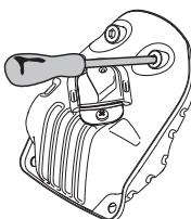
В некоторых глушителях предусмотрен специальный искрогаситель. Если ваша машина оборудована таким глушителем, сетку фильтра следует чистить раз в неделю. Наилучшие пользуются стальной щеткой. Забитая решетка приводит к работе с горячим двигателем, что дает серьезные повреждения двигателя.
