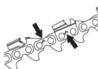
Для определения степени износа цепи мы рекомендуем проводить визуальное сравнение с новой цепью.
