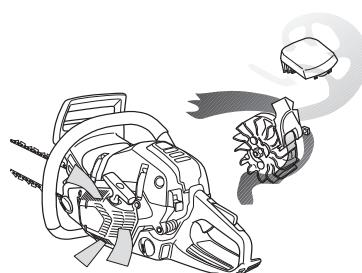
**ВАЖНО!** Для осуществления метода центробежной очистки нужно постоянно выполнять техническое обслуживание и уход за системой. Необходимо чистить воздухозаборник стартера, лопасти вентилятора на маховике, пространство вокруг маховика, входное коллектора и карбюратора.
