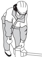
**PAŽNJA!** Izbjegavajte postavljanje dijelova tijela u označeni prostor. Kontakt može prouzročiti opekline na koži ili strujni udar u slučaju oštećenja lulice svjećice. Uvijek koristite rukavice. Ne koristite stroj s oštećenom lulicom svjećice.
