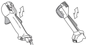
Убедете се, че пусковият механизъм и фиксаторът на дроселната клапа се движат свободно и възвратните пружини са в изправност.
