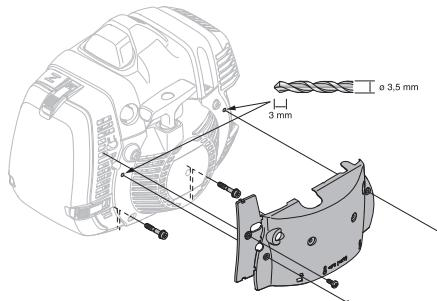
**ЗАПОМНЕТЕ!** Машината ТРЯБВА да бъде върната към стандартната си конструкция при температури, по-високи от 5°C. В противен случай съществува риск от прегряване в резултат на сериозна повреда на двигателя.
