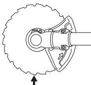
При разхлабване и затягане на гайката на резеца за сече, съществува рисък от нараняване от зъбите на резеца за сече. Стремете се, ръката ви винаги да е защитена от защитата на резеца, когато извършвате този
