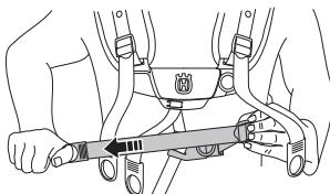
Регулирайте височината на висящия пръстен съгласно инструкциите. (При почистване на гори закачалките трябва да висят на около 10 см под бедрената кост.)
