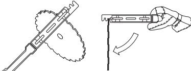
Проверявайте режещото оборудване за повреди и образуващи се пукнатини. Повредено режещо оборудване подлежи винаги на подмяня.
