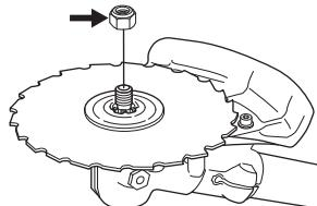
При монтирането гайката следва да се затяга в обратната посока на въртенето на режещото оборудване. При демонтиране гайката следва да се отвинта по посока на въртенето на режещото оборудване. (ЗАБЕЛЕЖКА! Гайката има левоходова резба.) При разхлабване и затягане на гайката на резеца за сечење, съществува рисък от нараняване от зъбите на резеца за сечење. Стремете се, ръката ви винаги да е защитена от защитата на резеца, когато извършвате този вид работа.
