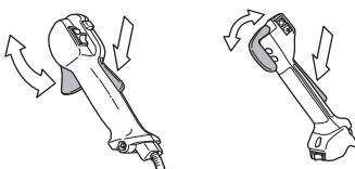
Вижте инструкциите в раздел Стартiranе. Стартирайте устройството и подайте пълна газ. Отпуснете регулятора на газ и се убедете, че режещото оборудване спира и остава неподвижно. Ако след като поставите подаването на газта на празен ход, режещото оборудване продължава да се върти, трябва да се провери регулировката на празния ход на карбуратора. Виж инструкциите в раздел Поддръжка.
