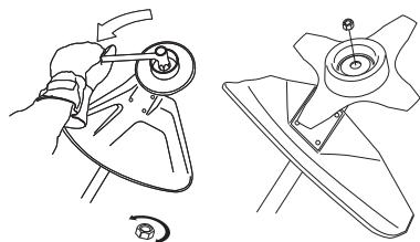
Найлоновото застопоряване на контрагайката не бива да бъде износено до степен, че да може да се върти с пръсти. Застопоряването трябва да издържа поне на усилие равно на 1,5 Нм. Гайката трябва да се смени след като е завинтвана около 10 пъти.
