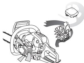
**ВАЖЛИВО!** Для підтримки роботи системи відцентрового очищення її треба регулярно доглядати. Прочистіть забирач повітря на стартері, ребра на маховику, простір біля маховику, впускну трубу та відсік карбюратора.
