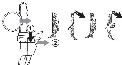
Направляючі вирізи повинні бути зроблені на глибину 1/4 діаметра стовбура та кут між нижнім та верхнім розрізами має бути 45°.
