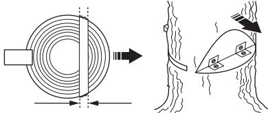
Контроль за напрямком падіння втрачається, якщо розріз падіння дуже вузький чи його не має, або якщо направляючі вирізи та виріз зрізування неправильно розташовані.
