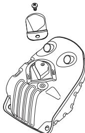
Глушник призначений для зменшення рівня шуму та відведення вихлопних газів подалі від користувача. Вихлопні гази мають високу температуру і містять іскри, які, потрапивши на сухі та легкозаймисті речовини, можуть привести до загоряння.
