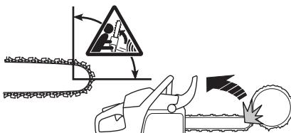
Віддача завжди виникає на ріжучій поверхні направляючої шини. Як правило ланцюгова пилка та направляюча шина відскакують уверх та убік користувача. Однак, ланцюгова пилка може рухатися й в іншу сторону в залежності від того, як вона використовувалась, коли зона віддачі направляюча шина доторкнулася об'єкту.
