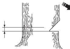
Установить шпичастий буфер (якщо є) перед шарніром падіння. Працуйте на повній швидкості та повільно уріжтеся ланцюгом/направляючою шиною в дерево. Упевніться в тому, що дерево не починає рухатися в напрямку, який зворотний тому, що Ви вибрали для валки. Забийте клин для валки дерев чи лом у розріз, як тільки він став досить глибоким.
