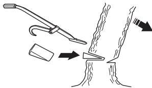
Ми рекомендуємо Вам користуватися направляючою шиною, довжина якої більше діаметра дерева, так щоб Ви могли з'єднати виріз зрізування та направляючий виріз одним розрізом. Інструкції дивіться в розділі під заголовком 'Технічні дані' стосовно того, яка довжина направляючої шини рекомендована для Вашої пилки.
