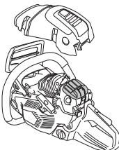
Фільтр може бути очищений ще краще промиванням його у воді з миючим засобом. Неможливо повністю очистити повітряний фільтр, який використовувався протягом довгого часу. Тому час від часу його слід замінювати. Пошкоджений фільтр обов'язково потрібно замінити.
