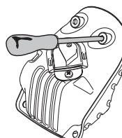
Дякі глушники обладнано іскропоглиняючими сітками. Якщо інструмент обладнано глушником такого типу, сітку слід чистити принаймні раз на тиждень. Найкраще робити це дротяною щіткою. Забруднена сітка приведе до перегрівання двигуна, що може спричинити серйозне його пошкодження.
