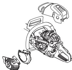
Систему охолодження слід чистити раз на тиждень, а якщо цього вимагають умови, то частіше. Робота з забрудненою або забитою системою охолодження спричинить перегрів двигуна, що приведе до пошкодження циліндрів та поршня.
