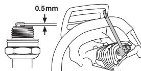
Beleška! Uvek upotrebjavaj preporučen tip svećice! Pogrešna svećica može da dovede do teškog oštećenja klipa/cilindra. Proveri da svećica ima tkz. zaštitu protiv radio valova.
