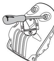
Neki prigušivači opremljeni su specijalnom mrežom. Ako tvoja mašina ima takav prigušivač treba mrežu čistiti bar jednom nedeljno, što se radi žičanom četkom. Blokirana mreža izazavaće pregrevanje mašine i može da dovede do ozbiljnih oštećenja.
