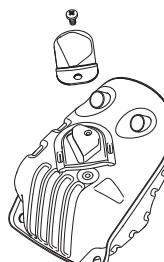
Prigušivač je zamišljen da smanji buku i usmeri izduvne gasove daleko od rukovatca. Izduvni gasovi su vredni i u njima zna da bude varnica, što može da izazove požar ako su gasovi usmereni na suv i zapaljiv materijal.
