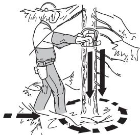
Odstrani svu vegetaciju oko drveta i proveri da u okolini nema prepreka (kamenja, grana, rupa itd.) da bi se mogao nesmetano udaljiti kad drvo počne da pada. Treba da se povlačiš ukoso za otprilike  $135^{\circ}$  od nameravanog pravca pada stabla.
