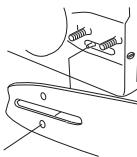
Zategni lanac pomoću kombinovanog ključa. Okreći zavrtanj za podešavanje lanca u pravcu kazaljke na satu. Lanac treba zatezati dok sasvim ne nalegne na donju stranu mača. Pogledajte uputstva pod naslovom Zatezanje lanca testere.
