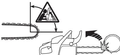
Lančana testera uvek odskače u ravni sečenja. Lančana testera i mač obično odskaču unatrag i nagore u pravcu rukovaoca. Ipak, lančana testera može da odskoci i u drugom smeru zavisno od načina na koji je upotrebljavana u trenutku kada je zona odskoka na maču dotakla predmet.
