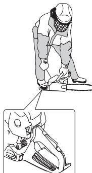
Pošto je kočnica lanca i dalje aktivirana mora se ubrzo broj obrta motora smanjiti na prazan hod, što se postiže na taj način da se iskopča zapreka gasa. Sa ovim izbegavaš nepotrebno habanje kvačila, bubenja kvačila kao i kaiša za kočenje.
