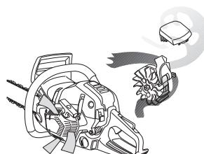
**VAŽNO!** Za trajno funkcioniranje centrifugalnog čišćenja potrebno su stalno održavanje i briga. Očisti ulaz vazduha u starter, elise zamajca, prostor oko zamajca, ulaznu cev i karburatorski prostor.
