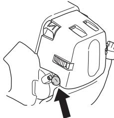
**Заслонка топлива:** Установите заслонку топлива в положение сътнения.
