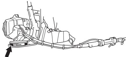
Система гашения вибрации машины снижает передачу вибраций.
