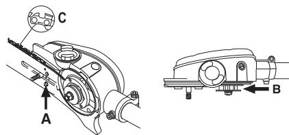
Для этого поверните винт механизма регулировки цепи по часовой стрелке. Цепь следует натягивать до тех пор, пока она не будет плотно прилегать к нижней стороне пильного полотна.
