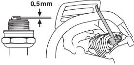
**Σημείωση!** Χρησιμοποιείτε πάντοτε τον τύπο μπουζιού που συστήνεται! Λάθος τύπος μπορεί να προκαλέσει ζημιά στο έμβολο/κύλινδρο. Ελέγξτε αν το μπουζί είναι εφοδιασμένο με συμπίεστή.
