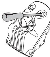
Ορισμένοι σιγαστήρες έχουν ένα ειδικό δικτυωτό φίλτρο σπινθήρων. Αν το μηχανήμα σας έχει έναν τέτοιο σιγαστήρα, θα πρέπει να καθαρίζετε το δικτυωτό φίλτρο μια φορά τη βδομάδα. Χρησιμοποιήστε για καλύτερο αποτέλεσμα μια ατσαλόβουρτσα. Ένα βουλωμένο δίχτυ προκαλεί υπερθέρμανση του κινητήρα με σοβαρή βλάβη του ως αποτέλεσμα.
