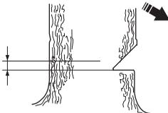
Τοποθετήστε τον οδοντωτό προφυλακτήρα (αν έχει το μηχάνημα) πίσω από τη λωρίδα ανατροπής. Δώστε φουλ γκάζι και πριονίστε με αργή κίνηση. Προσέχετε συγχρόνως μήπως το δέντρο κινείται προς αντίθετη κατεύθυνση απ' αυτήν που διαλέξατε. Βάλτε μια σφήνα
