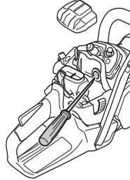
Για θερμοκρασίες κάτω των -5°C και/ή συνθήκες χιονιού διατίθεται ένα ειδικό κάλυμμα, το οποίο βρίσκεται στερεωμένο στο περίβλημα του συστήματος εκκίνησης.
