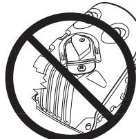
Pravidelne kontrolujte, či je tlmič výfuku pevne pripojený k motoru.
