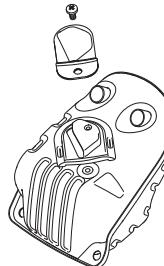
Tlumič výfuku je určen ke snížení úrovně hluku a k usměrnění výfukových plynů směrem od uživatele. Výfukové plyny jsou horké a mohou obsahovat jiskry, které by mohly způsobit požár, pokud by byly nasměrovány proti suchému a hořlavému materiálu.
