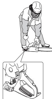
Kedže brzda reťaze je ešte v činnosti, je nutné nastaviť otáčky motoru na voľnobeh čo najrýchlejšie; dosiahnete to rýchlym uvoľnením páčky plynu. Týmto postupom sa zabráňuje zbytočnému opotrebovaniu spojky, bubna spojky a brzdového pásu.
