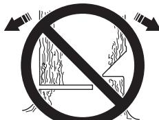
Po dokončení směrového zářezu a hlavního řezu by se strom měl začít káct samovolně nebo pomocí dřevorubeckého klínu či pácidla.
