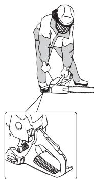
Pošto je kočnica lanca i dalje aktivirana mora se ubrzano broj obrta motora spustiti na prazan hod, što se postiže na taj način da se iskopča zapreka gasa. Sa ovim izbjegavate nepotrebno habanje kvačila, bubenja kvačila kao i kaiša za kočenje.
