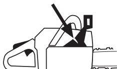
フロントハンドガードを前後に動かしてみて、スムーズに動くか、クラッチカバーで確実に止まるなどを点検します。
