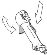
Skatiet norādījumus zem rubrikas Iedarbināšana. Iedarbiniet mašīnu un padodiet pilnu gāzi. Atlaidiet droseli un pārbaudiet, vai griešanas aprikojums apstājas un paliek nekustīgs. Ja griešanas aprikojums griežas, kad drosele ir tukšgaitas pozīcijā, tad jāpārbauda karburatora tukšgaitas noregulējums. Skatiet norādījumus zem rubrikas Apkope.
