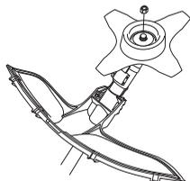
Montējot, piegrieziet uzgriezni pretēji griešanas aprikojuma rotācijas virzienam. Demontējot, atgrieziet uzgriezni griešanas aprikojuma rotācijas virzienā. (IEVĒROT! Uzgriežņa vītne ir pa kreisi.) Pievelciet uzgriezni, izmantojot šarnīra uzgriežņu atslēgu.
