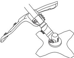
Patikrinkite, ar apsauginis skydas nepažeistas ir neįskilęs. Smūgio deformuotą ar įskilusį apsauginį skydą pakeiskite.
