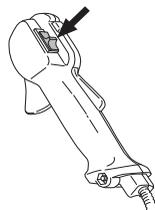
**UZMANĪBU!** Stop kontakts automātiski atgriežas iedarbināšanas pozīcijā. Lai izvairītos no nejaušas iedarbināšanas, aizdedzes sveces uzgalis vienmēr ir jāatvieno no aizdedzes sveces jebkurā montāžas, kontroles un/vai apkopes gadījumā.
