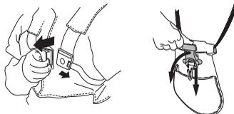
Kontrolli, kas rakmed asetsevad õigesti. Kui rakmed ja seade on korda seatud, kontrolli kiirkinnituse töötamist.
