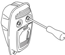
Kui seadmel on summuti, mis on varustatud sädeleidpüüdjaga, peab ka seda ühtlaste ajavahemike järel puhastama. Saastunud võrguga sädeleidpüüdja tõttu võib mootor üle kuumeneda ja katki minna.
