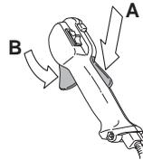
Patikrinkite, ar laisvoje eigoje akseleratorius yra užblokuotas, o akseleratoriaus gaiduko blokatorius yra savo pirminėje padėtyje.
