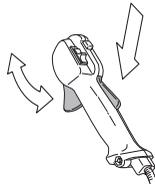
Žr. nuorodas Įjungimas. Užveskite įrenginį ir stipriai spūstelkite akseleratoriaus gaiduką. Atleiskite akseleratorių ir patikrinkite,
