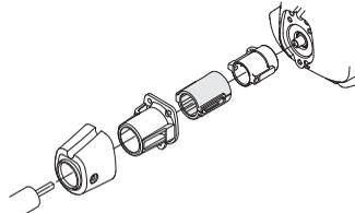
Reguliariai tikrinkite antivibracinės sistemos detales: jos turi būti nepažeistos ir nedeformuotos.
