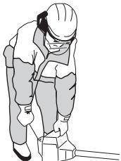
**PAŽNJA!** Ne stavljamte dijelove tijela u označeni prostor. Kontakt može prouzrokovati opekotine na koži ili strujni udar ako je lulica svjećice oštećena. Uvijek koristite rukavice. Ne koristite stroj sa oštećenom lulicom svjećice.
