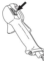
**PAŽNJA!** Stop prekidač se automatski vraća na start poziciju. Da bi se spriječilo nenamjerno paljenje, poklopac ručice za paljenje mora biti skinut sa ručice za paljenje tokom montiranja, provjeravanja i/ili servisiranja.
