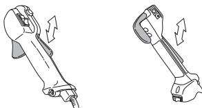
Перевірте, чи фікатор та важіль ходять вільно, і чи добре працюють відвідні пружини .
