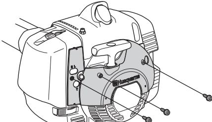
Зніміть кришку повітряного фільтра і витягніть фільтр з інструменту. Установіть повітряний фільтр і кришку із зимового комплекту.
