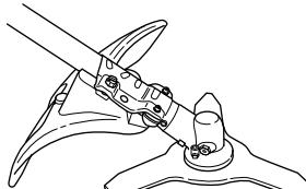
Перевірте, чи кожух не пошкоджений та чи на ньому немає тріщин. Замініть кожух, якщо він зазнав удару або має тріщину.
