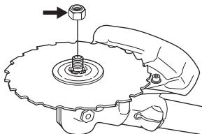
Встановлюючи ріжучу насадку, затягуйте гайку в бік, протилежний напрямку обертання насадки. Щоб зняти насадку, відкручуйте гайку в бік обертання. (УВАГА! Гайка має лівобічну нарізку.) Послаблюючи чи затягуючи гайку пилки, можна поранитися об зубці пилки. Отже, при виконанні такої роботи слід тримати руку з боку, що прикритий захисним кожухом. Для цього завжди користуйтесь торцевим гайковим Ключем із стержнем достатньої довжини.
