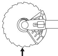
Послаблюючи чи затягуючи гайку пилки, можна поранитися об зубці пилки. Отже, при виконанні такої роботи слід тримати руку з боку, що прикритий захисним кожухом. Для цього завжди користуйтеся торцевим гайковим ключем із стержнем достатньої довжини. Стрілка на
