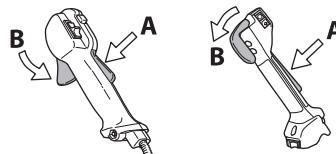
Перевірте, чи важіль фіксується у позиції холостої роботи при відпусканні фіксатора.
