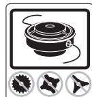
Používajte len nekovové flexibilné zastrihovacie nástroje, t. j. trimovacie (vyžinacie) hlavy s vyznačením lankom.
