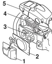
Производите очистку системы охлаждения щеткой раз в неделю или чаще, если этого требуют условия работы. Загрязненная или засоренная система охлаждения может привести к перегреву машины и вызвать повреждение поршня и цилиндра.
