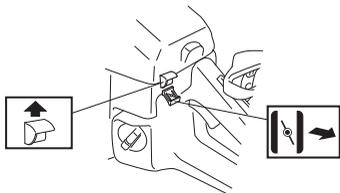
Если машина укомплектована топливным насосом (А): Сожмите несколько раз резиновую грушу топливного насоса пока в нее не начнет поступать топливо. Грушу нет необходимости заполнять полностью.
