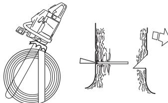
Закончить основной пропил нужно параллельно линии направляющего пропила так, чтобы расстояние между ними составляло около 1/10
