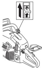
Для включения подогрева, выключатель должен быть переведен в верхнее положение. Для выключения подогрева – в нижнее положение.
