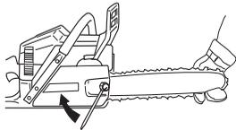
При установке новой цепи следует часто проверять ее натяжение, пока цепь не начнет работать. Регулярно проверяйте натяжение цепи. Регулярно проверяйте натяжение цепи. Правильно натянутая цепь обеспечивает высокое качество пиления и дольше служит.
