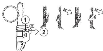
Направляющий пропил делается на глубину 1/4 ствола и угол между верхним и нижним
