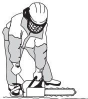
Твердо возьмите моторную пилу, обхватив ручки всей ладонью.
