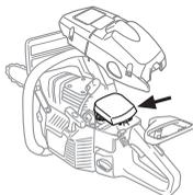
Для более тщательной чистки фильтр следует помыть в воде с мылом.
