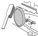
Регулярно проверяйте, чтобы лента тормоза была по крайней мере толщиной минимал 0.6 мм в самом изношенном месте.
