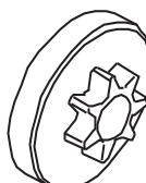
Verifique regularmente o nível de desgaste do pinhão da corrente. Substitua-o caso apresente desgaste anormal. O pinhão deverá ser trocado a cada substituição de corrente.
